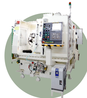
▼ 多功能五轴联动研磨设备, 配备砂轮库,
