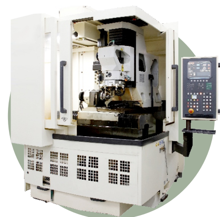
▲ 慢走丝线切割设备, 受新刀厂家青睐, 可应对各种形状复杂的非标刀具。
