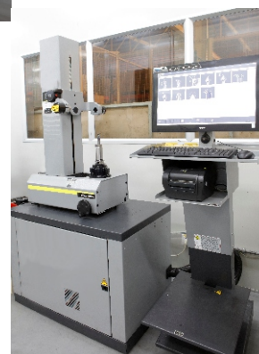
▲ 专业软件描点修形，精确再现剃刀几何精度。
