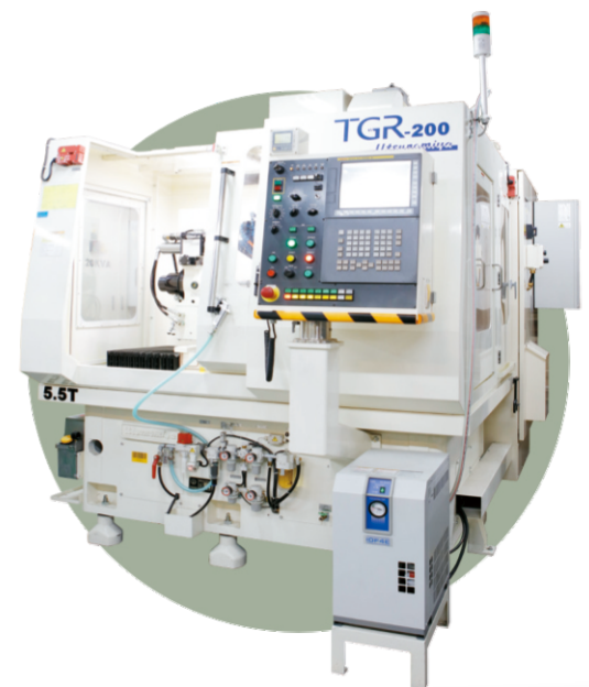
▲ 多功能五轴联动研磨设备，配备砂轮库可自动更换砂轮，减少研磨误差。
