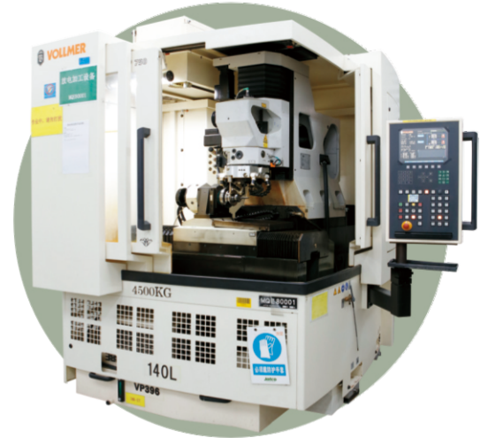
▲ 慢走丝线切割设备，受新刀厂家青睐，可应对各种形状复杂的非标刀具。
